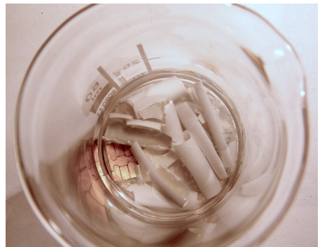
Entfernen von Thermoplasten mittels Aceton
