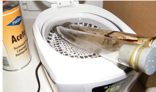
Reinigung der Halbleiterplättchen im Ultraschallreiniger
