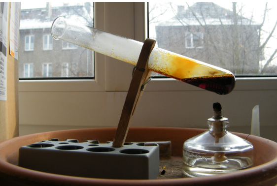
IC-Entkapselung durch Kochen in Kolophonium
